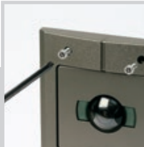
1 Dévisser les 4 vis à l'aide de la clé prévue à cet effet
